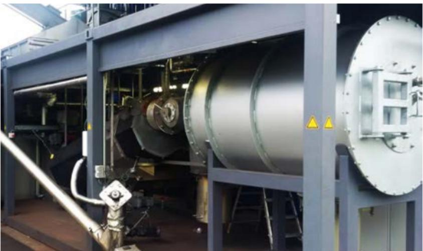
Eine Klärschlamm-Pyrolyseanlage von Pyreg
